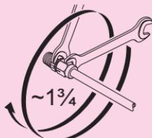
Anschlussmutter mit Gabelschlüssel ca. **1 3/4 Umdrehungen** anziehen.
