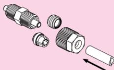
**Rohr bis zum Anschlag** in die Verschraubung einführen. Prüfen, ob der Schlauch durch den ganzen Klemmring geschoben worden ist.
